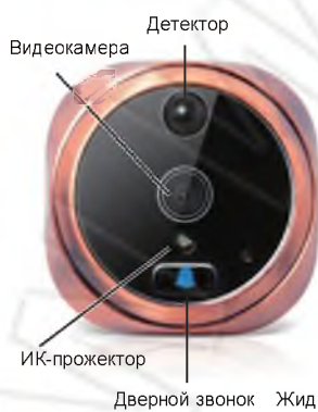
Компонент устройства, устанавливаемый на наружной поверхности двери
