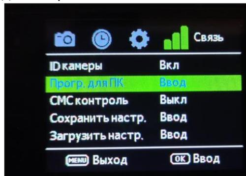
Сохраните программу настройки на карту памяти. Подключите фотоловушку к компьютеру с помощью USB кабеля (она определится как съёмный диск) или установите карту памяти из камеры в кард-ридер вашего компьютера. Программа настройки работает только с операционной системой Windows.
